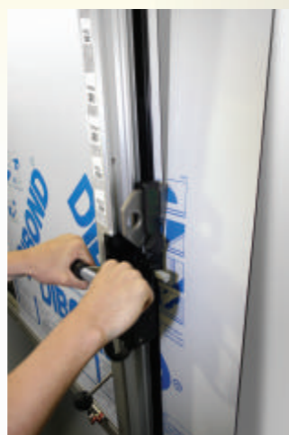
Tnie płytę Dibond grubą do 4mm jednym ruchem zostawiając gładkie krawędzie za każdym razem.
